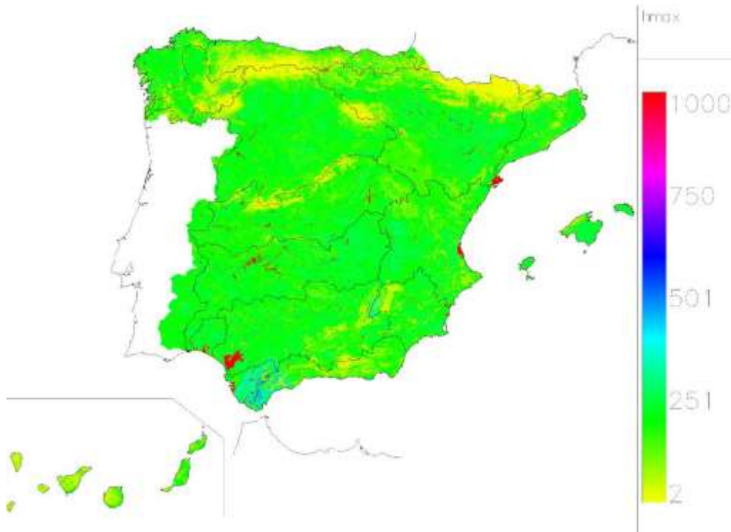
Figura 22 Capacidad máxima de almacenamiento de agua en el suelo, H_{m\acute{a}x} (mm)
