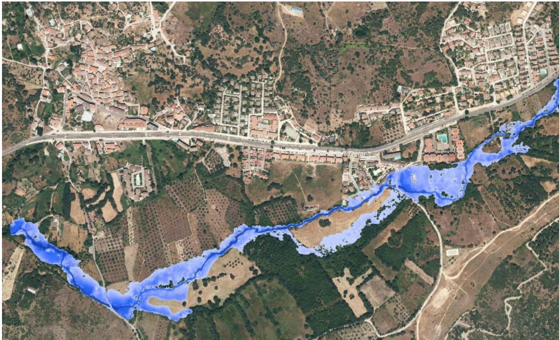
Figura 4: Distribución de calados para la avenida de 500 años de periodo de retorno del río Tiétar a su paso por Santa María de Tiétar (Ávila)
