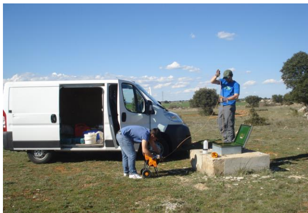
Toma de muestras de agua subterránea
