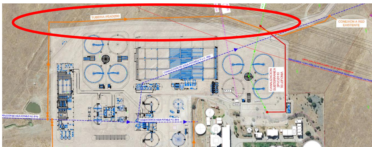
Imagen 3. Retranqueo de la línea de acometida de agua de potable.
