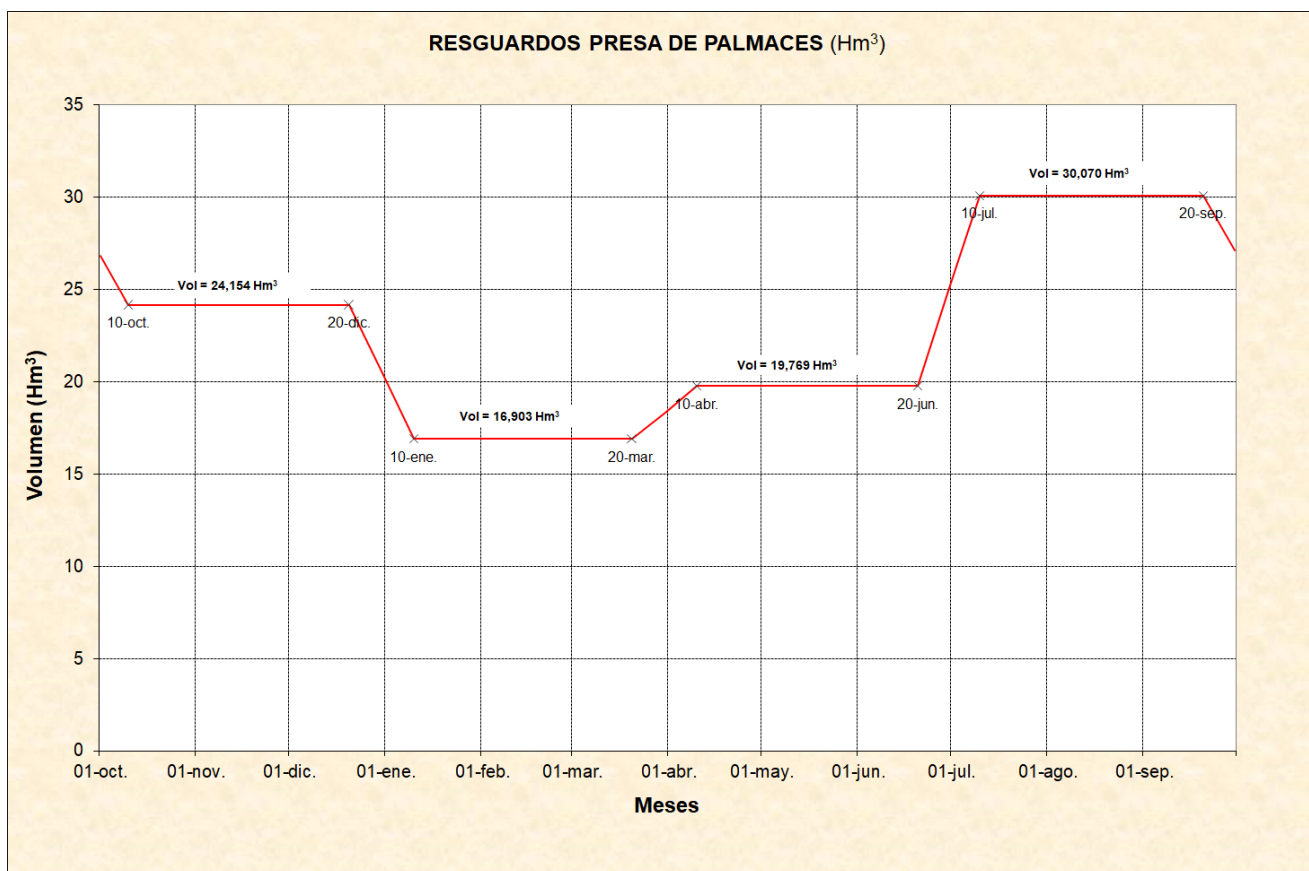
Resguardos estacionales – Presa de Pálmaces
