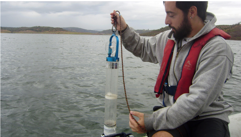
Figura 12. Botella hidrográfica para la recogida de muestras de agua a diferentes profundidades en los embalses
