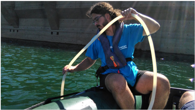
Figura 13. Toma de muestras de agua en una muestra integrada parcial o una muestra integrada en la columna metro a metro
