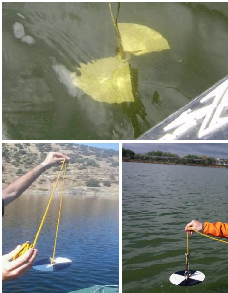
Figura 11. Uso del disco de Secchi para medir la transparencia y determinar la profundidad de la capa fótica
