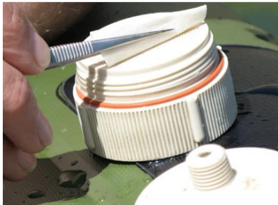
Figura 19. Filtro de fibra de vidrio utilizado para la filtración de agua para el análisis de clorofila
