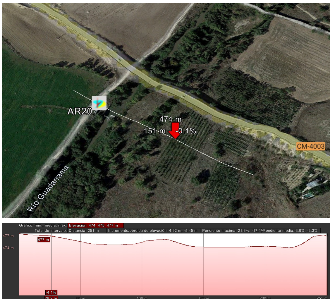
Sección transversal estación de aforos AR20
