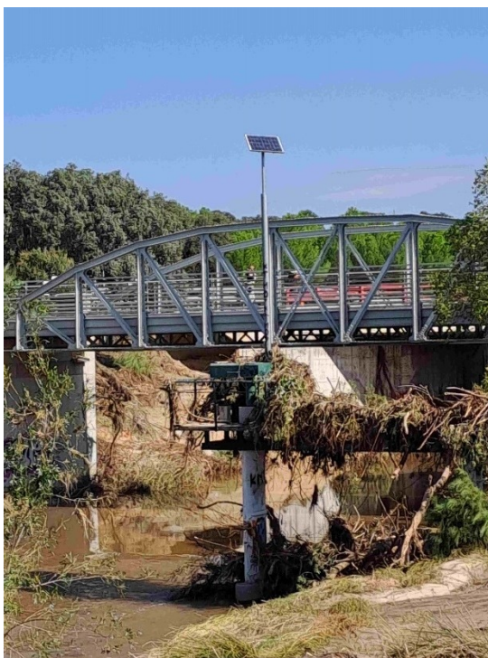
Estado de la estación del río Perales tras el paso de la avenida
