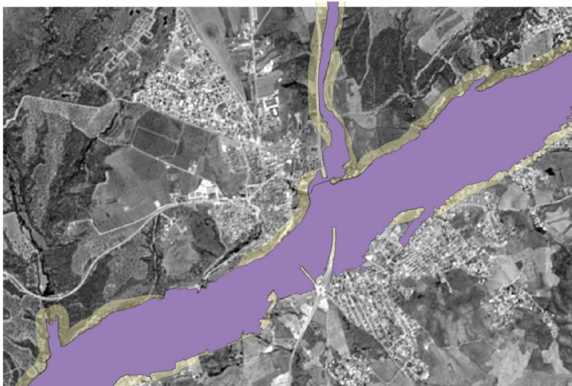
Zona inundable para T10 y MCO en Escalona
