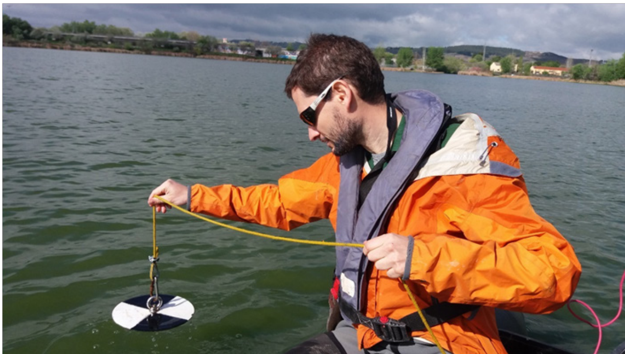
Figura 20. Medición de la transparencia mediante el Disco de Secchi
