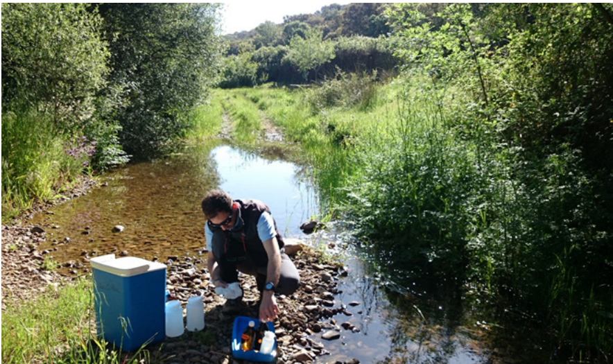
Figura 22. Recogida y conservación de muestras de agua para evaluar la calidad fisicoquímica
