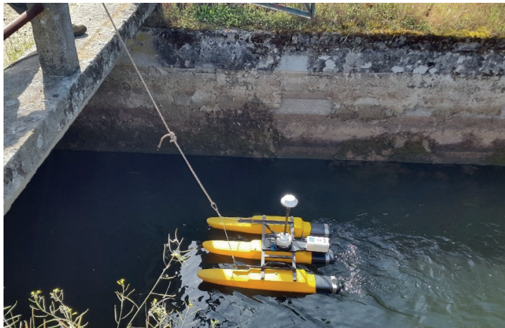
Realizando un aforo con el M9 en el Canal de Rosarito
