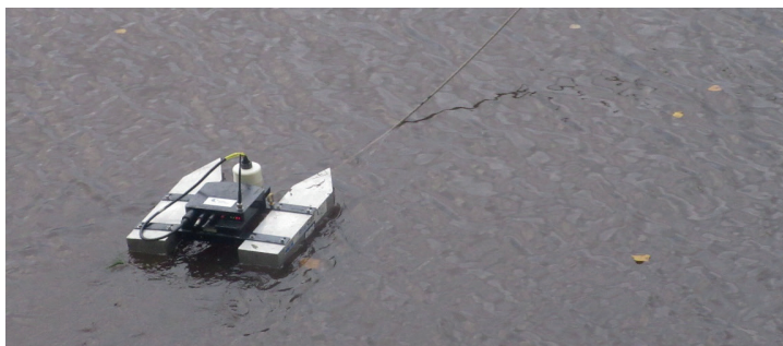
Detalle del RiverCat aforando Marco de Control en Coria
