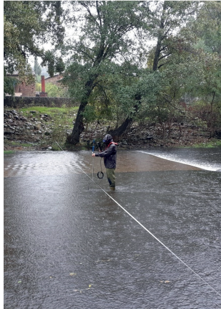
Realizando aforo en Garganta Jaranda con FlowTracker
