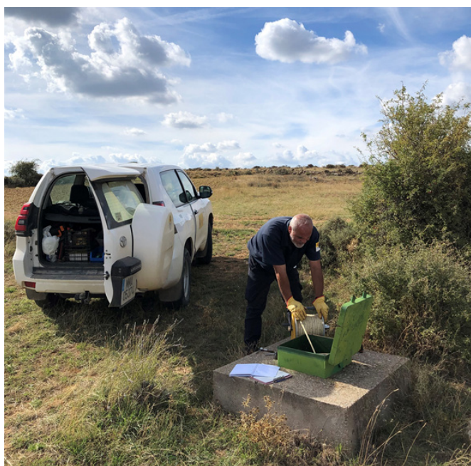
Foto 44. Trabajos de medición de niveles en un sondeo de la red de piezometría.
