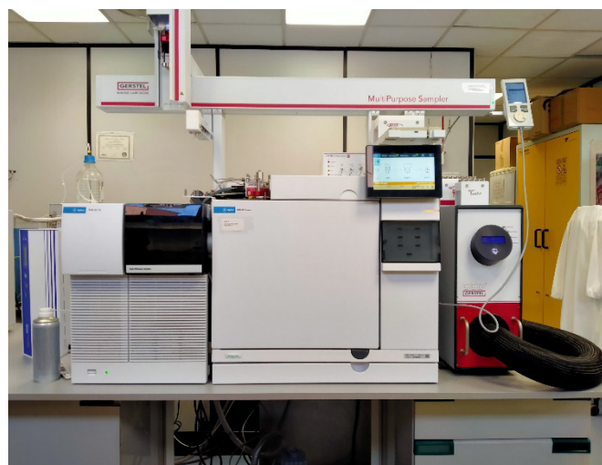
Foto 32. Cromatógrafo de gases con detector de masas triple cuadrupolo (TWISTER) para la determinación de plaguicidas en agua
