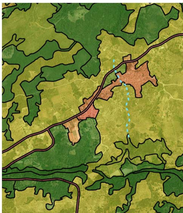
Figura 12. Distribución espacial del coeficiente de rugosidad de Manning a partir la cartografía de usos del suelo del SIOSE y su revisión con la ortofoto PNOA de Máxima Actualidad (imagen correspondiente al arroyo Buitreras)
