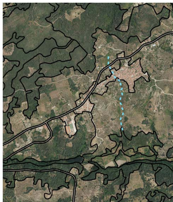
Figura 12. Distribución espacial del coeficiente de rugosidad de Manning a partir la cartografía de usos del suelo del SIOSE y su revisión con la ortofoto PNOA de Máxima Actualidad (imagen correspondiente al arroyo Buitreras)
