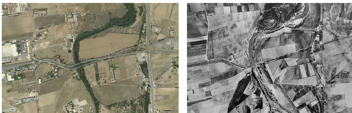
Figura 10. A la izquierda, la ortofoto del PNOA de máxima actualidad del río Jarama en San Sebastián de los Reyes (Madrid) y a la derecha, el fotograma del vuelo del 56 georreferenciado para la misma zona.
