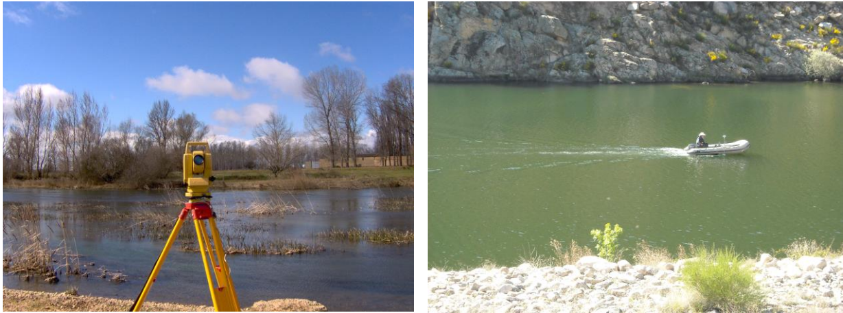
Figura 3. Toma de datos cauce mediante estación total y ecosonda acoplada a embarcación
