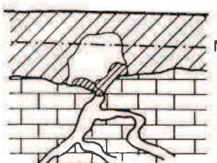
C 1 ) Ascenso de nivel y calda de paredes del hueco
