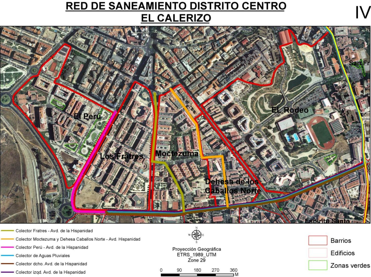
Figura 65. Red de Saneamiento de Cáceres de la zona de El Calerizo IV.
