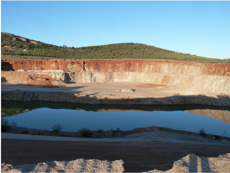
Foto 10. Cantera La Olleta. Extracción de dolomías de El Calerizo. Se observa un lago cuyo nivel corresponde con el nivel freático local. En esta parte la superficie de El Calerizo es relativamente plana. La siguiente fotografía muestra un detalle ampliado de esta imagen.
