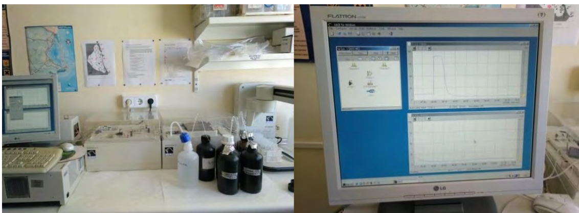
Figura 14. Análisis de nutrientes mediante el Autoanalizador SEAL AA3 HR.
