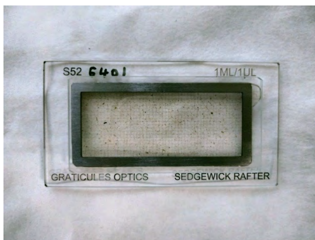
Figura 19. Microscopio y cámara de conteo Sedgewick para el estudio del zooplancton.
