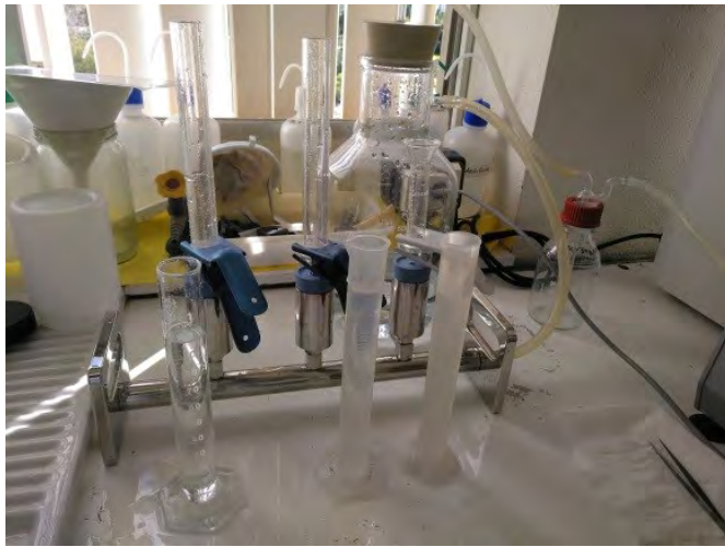
Figura 13. Rampa de filtrado y filtros para la determinación de los materiales en suspensión.
