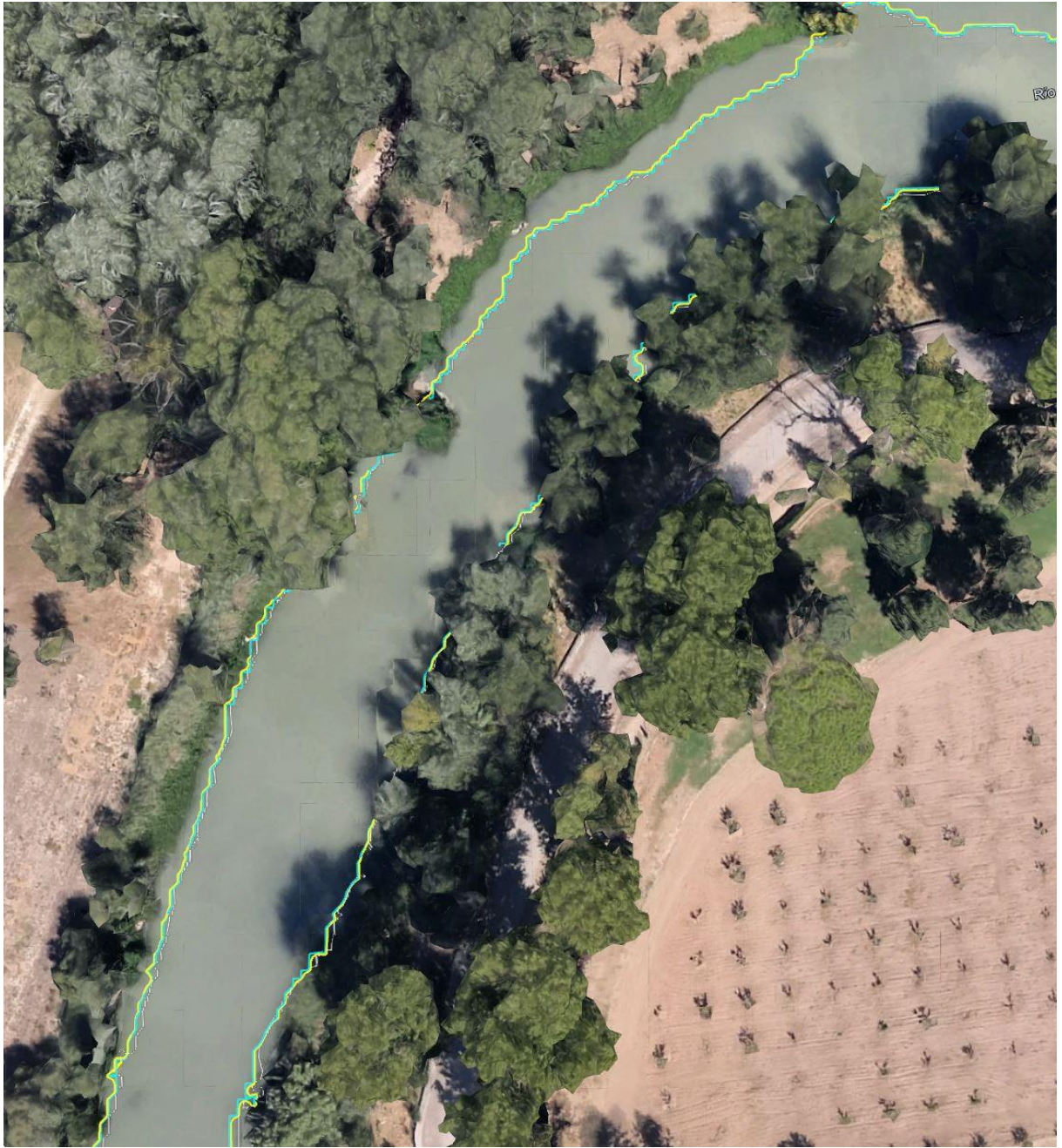
Figura 26. Alturas de la lámina de agua en Aranjuez para caudales mínimos 6-8.5 (detalle)
