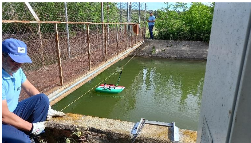
Foto: Medida del caudal circulante en canal con sensor RS5
